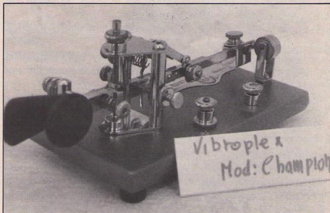
Figura 1. Perspectiva del manipulador semiautomático de la marca Vibroplex, modelo Champion, visto desde su ángulo inferior de la derecha. Los bornes de conexión, el amortiguador G, la pesa deslizante y los ajustes F y D (figura 3) quedan en primer plano.
